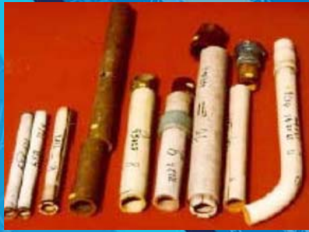
شکل ۱: نمونه لوله‌های خارج شده از زیر خاک پس از ۵۰ سال
